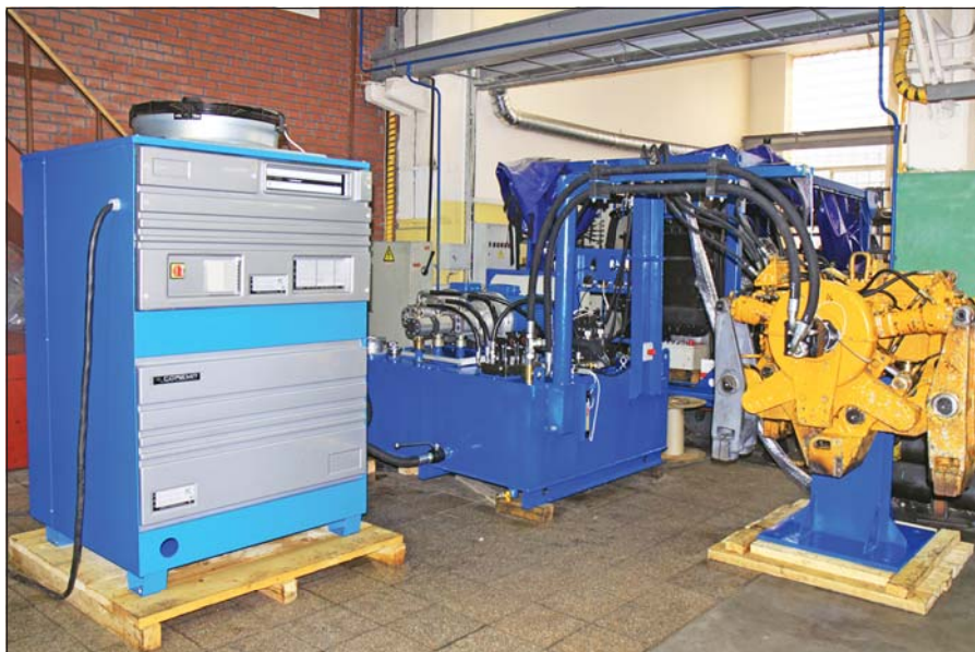
Стенд с подключенным подбивочным блоком
