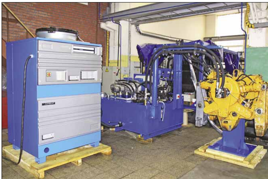
Стенд с подключенным подбивочным блоком
