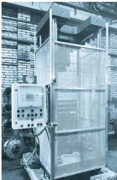
Типы колесных пар трамваев, подлежащие запрессовке/ распрессовке - 5Т24 с редуктором 1Т21
