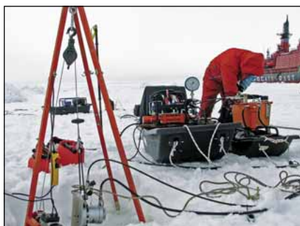
Испытательный комплекс для исследования механических свойств льда
