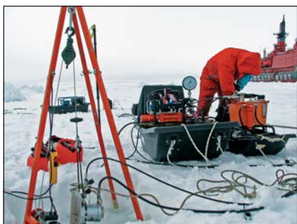
Испытательный комплекс для исследования механических свойств льда
